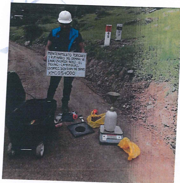
FOTOGRAFÍA N°6. Ensayo N°06 de Densidad de Suelo en Campo (Método del cono de arena) en la progresiva Km 05+000.
