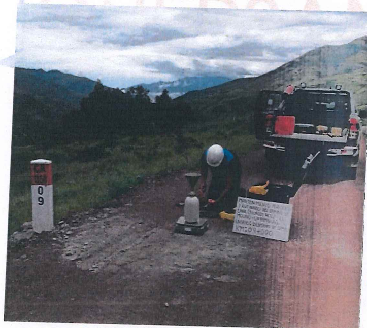
FOTOGRAFÍA N°14. Ensayo N°14 de Densidad de Suelo en Campo (Método del cono de arena) en la progresiva Km 09+000.
