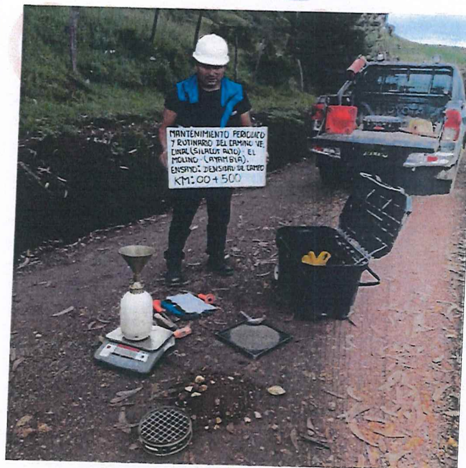
FOTOGRAFÍA N°2. Ensayo N°02 de Densidad de Suelo en Campo (Método del cono de arena) en la progresiva Km 00+500.
