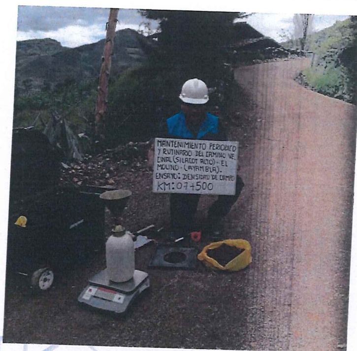
FOTOGRAFÍA N°11. Ensayo N°11 de Densidad de Suelo en Campo (Método del cono de arena) en la progresiva Km 07+500.
