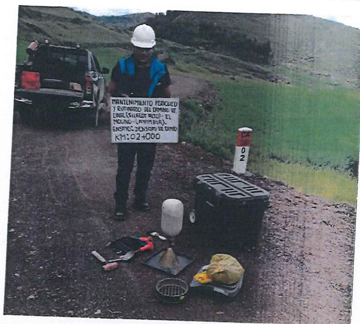
FOTOGRAFÍA N°5. Ensayo N°05 de Densidad de Suelo en Campo (Método del cono de arena) en la progresiva Km 02+000.
