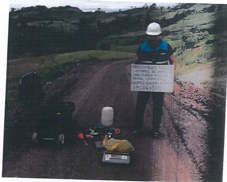
FOTOGRAFÍA N°9. Ensayo N°09 de Densidad de Suelo en Campo (Método del cono de arena) en la progresiva Km 06+500.
