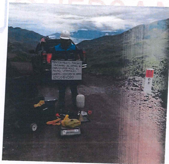
FOTOGRAFÍA N°12. Ensayo N°12 de Densidad de Suelo en Campo (Método del cono de arena) en la progresiva Km 08+000.
