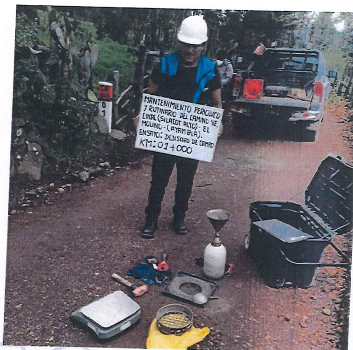
FOTOGRAFÍA N°3. Ensayo N°03 de Densidad de Suelo en Campo (Método del cono de arena) en la progresiva Km 01+000.
