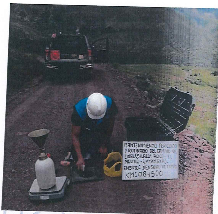
FOTOGRAFÍA N°13. Ensayo N°13 de Densidad de Suelo en Campo (Método del cono de arena) en la progresiva Km 08+500.
